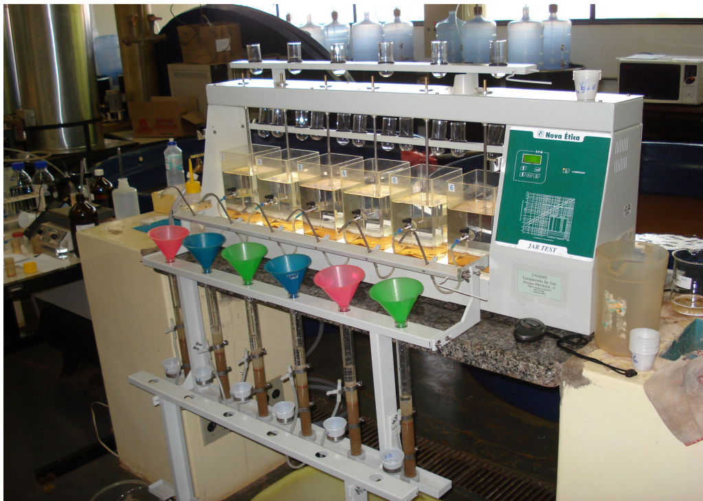
Figura 15: Fotografia do equipamento estático do tipo Jarteste em operação de ensaios de ciclo completo
