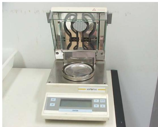
**Figura 9b** Analisador de Umidade Sartorius
