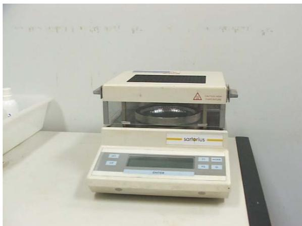
**Figura 9a** Analisador de Umidade Sartorius
