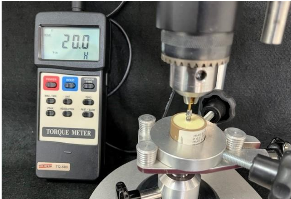
Figura 7. Fotografia do torquímetro instalado no suporte para a aplicação do torque
