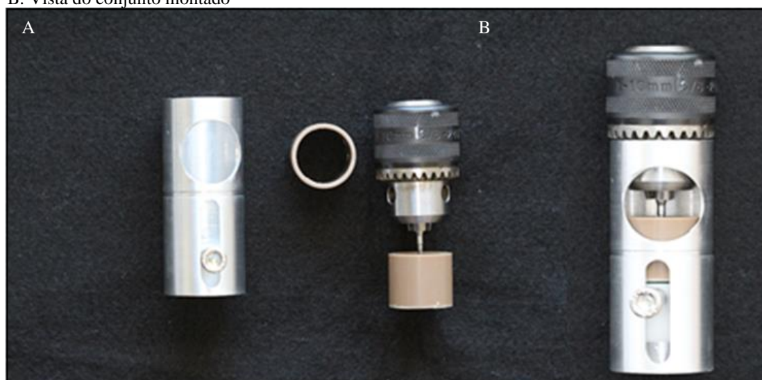
Figura 3. Fotografia do cilindro de PVC e dispositivo para sua centralização: A. Vista do dispositivo; B. Vista do conjunto montado
