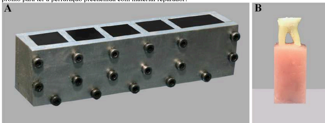
Figura 5. A) Matriz de alumínio desmontável, aparafusável, com formato de paralelepípedo com base quadrada foi utilizado para posicionamento das raízes na confecção dos corpos de prova. B) Corpo de prova finalizado, pronto para ter a perfuração preenchida com material reparador.
