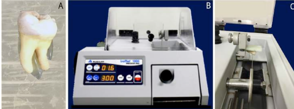
Figura 1. A) Molar inferior humano fixado em placa de acrílico com auxílio de cola quente. B) Máquina de corte Isomet. C) Conjunto placa de acrílico/ dente posicionado na Isomet para secção da coroa a 3 mm da junção amelocementária.
