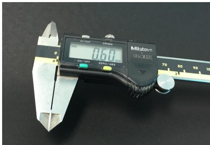
Figura 5. Verificação da espessura do disco cerâmico
