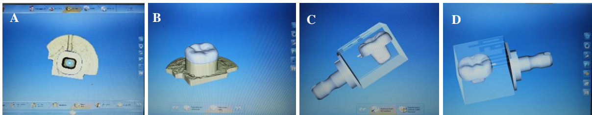
Figura 11 . A. Delimitação do término, B. finalização do desenho, C e D posicionamento da endocrown no bloco para fresagem.
