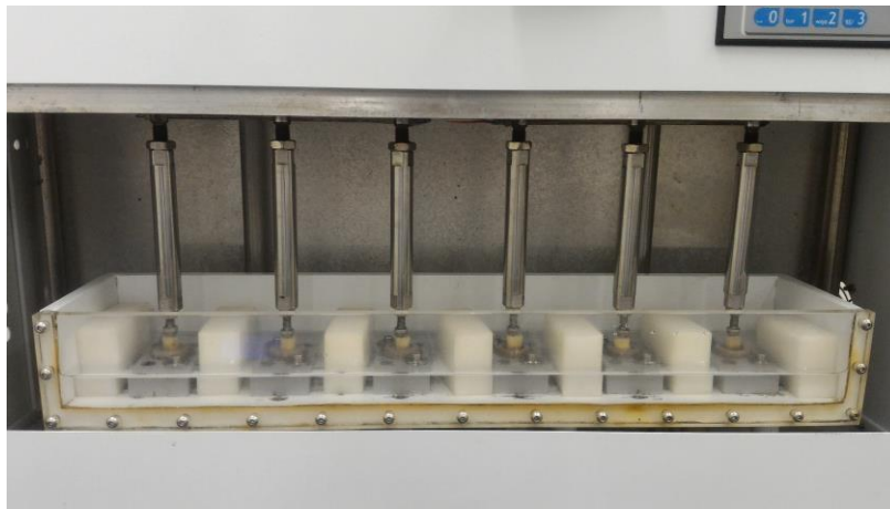
Figura 21 Ensaio de fadiga termomecânica acelerada em um simulador de mastigação pneumático
