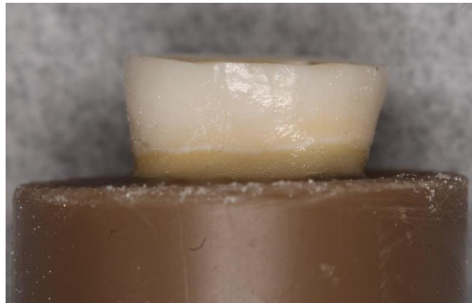
Figura 6. Inclusão dos dentes em cilindros de PVC
