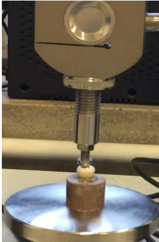
Figura 23. Teste de compressão em máquina universal de ensaio com célula de carga de 1000 Kgf (Biopdi, São Carlos, SP, Brasil).
