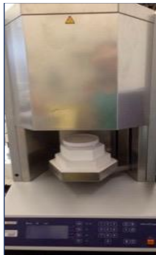
Figura 10. Forno InFire HTC Speed para o processo de sinterização do grupo GZ.
