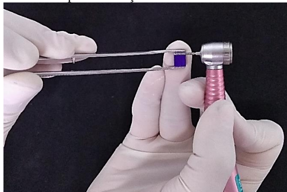
Figura 14. Posicionamento da amostra e ponta diamantada para realização do acabamento.
