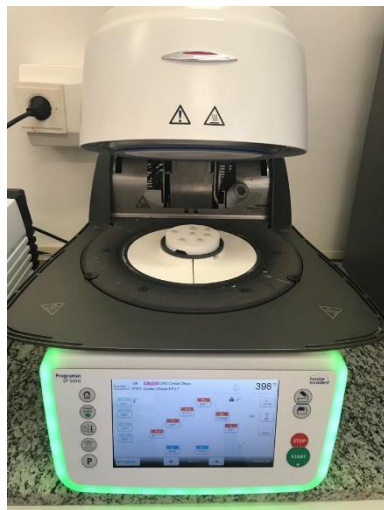
Figura 9. Forno P500 para o processo de cristalização dos grupos GD e GS.
