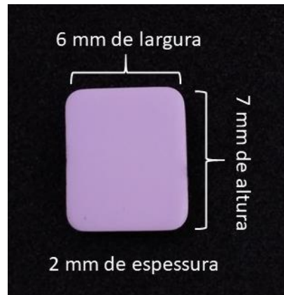
Figura 5. Dimensões finais dos corpos de prova.
