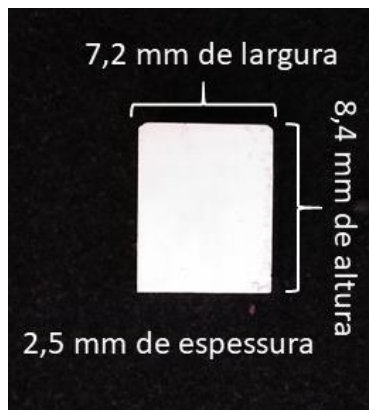
Figura 6. Dimensão da zircônia monolítica antes da sinterização.
