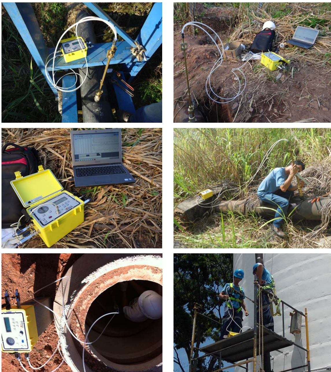
Figura 26. Monitoramento das vazões por pitometria realizado no presente trabalho
