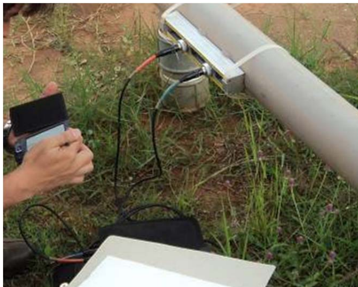
Figura 3. Macromedidor de vazão portátil ultrassônico utilizado no presente trabalho.
