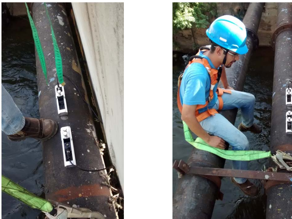
Figura 27. Monitoramento das vazões por medidor portátil ultrassônico realizado no presente trabalho
