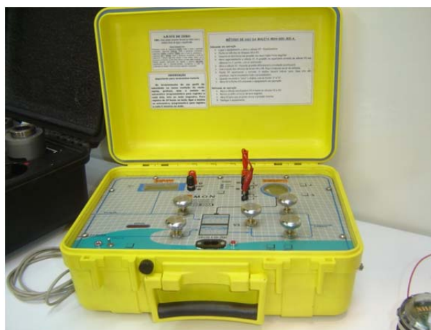
Figura 15. Equipamento utilizado na pitometria para obter dados de vazão e pressão.
