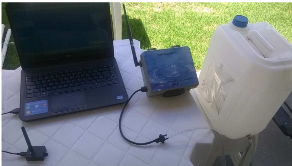
Figura 28 – Cenário inicial de calibração dos sensores em bancada
