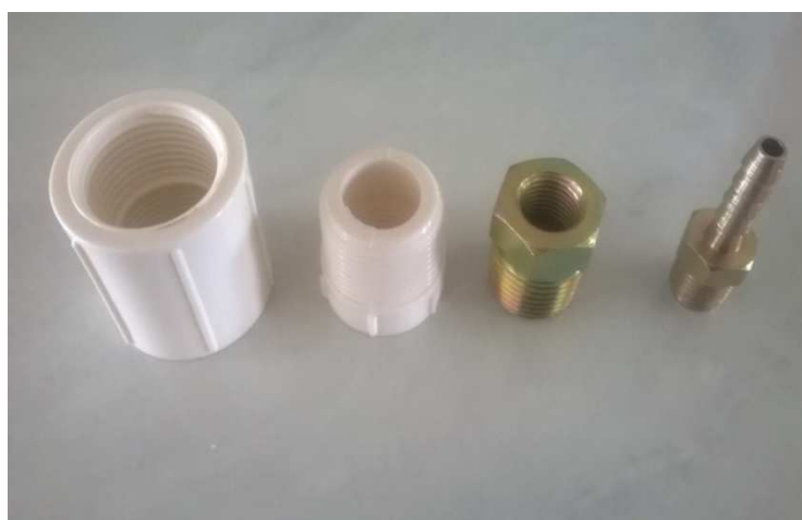
Figura 29 – Conexões para redução ao diâmetro do sensor de pressão
