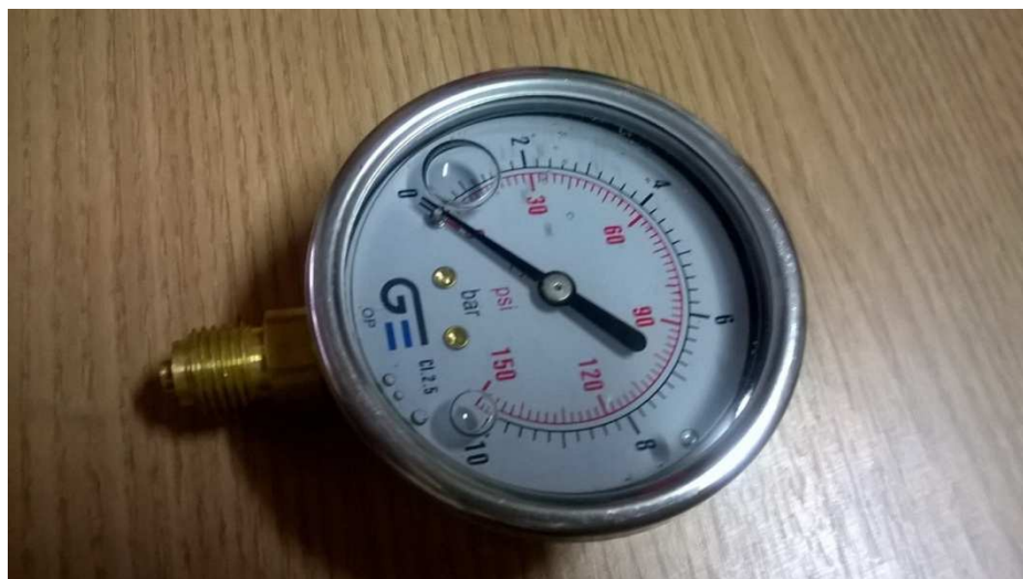
Figura 22 – Manômetro utilizado para certificação e calibração da precisão do sensor de pressão MPX5700DP
