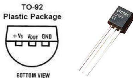
Figura 11 – Pinagem e aspecto físico do LM 35
