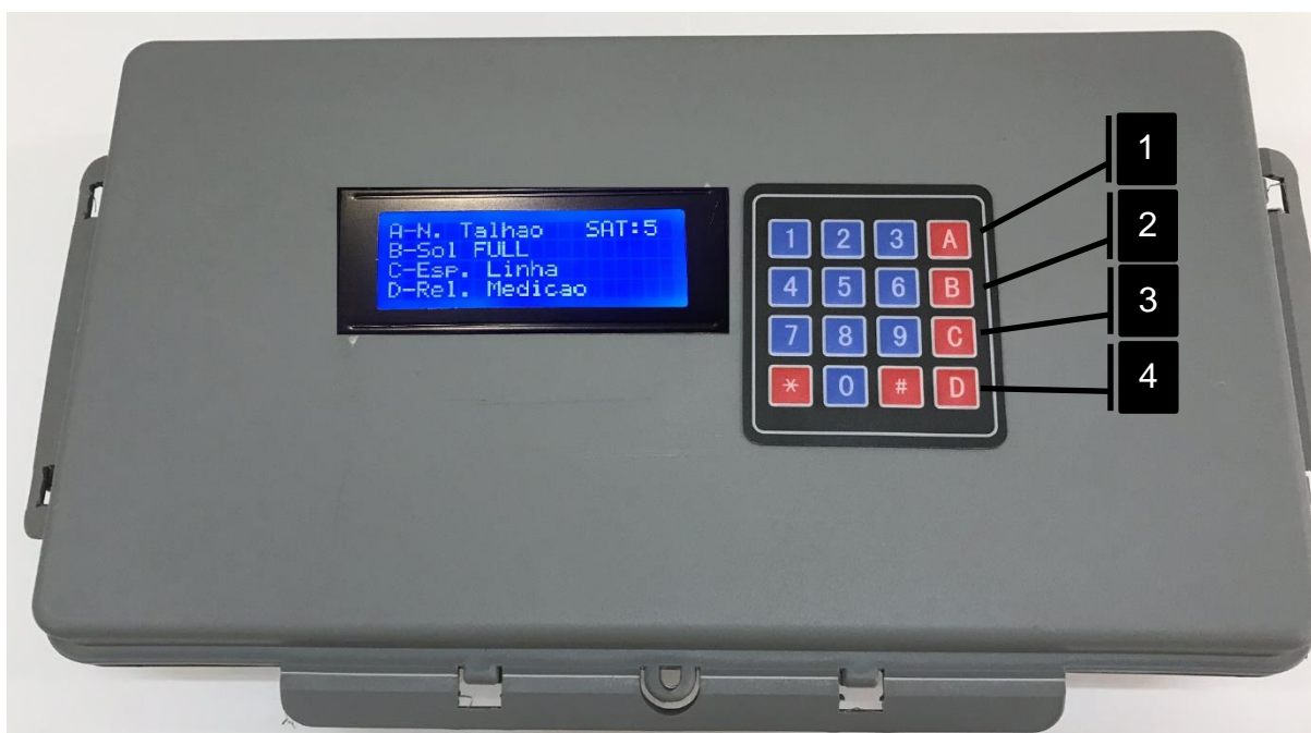
Figura 41: Teclado alfanumérico e o Módulo Display LCD 20x4 com tecnologia I2C utilizado para visualização das informações do projeto
