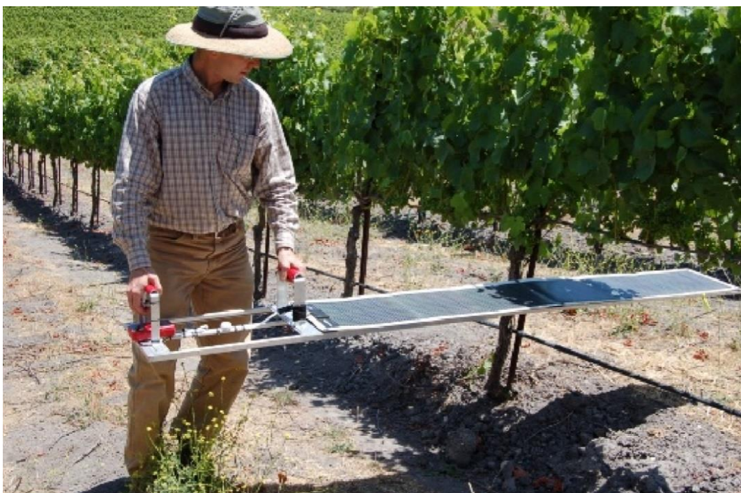
Figura 4: Painel solar para medir a área sombreada da copa das plantas
