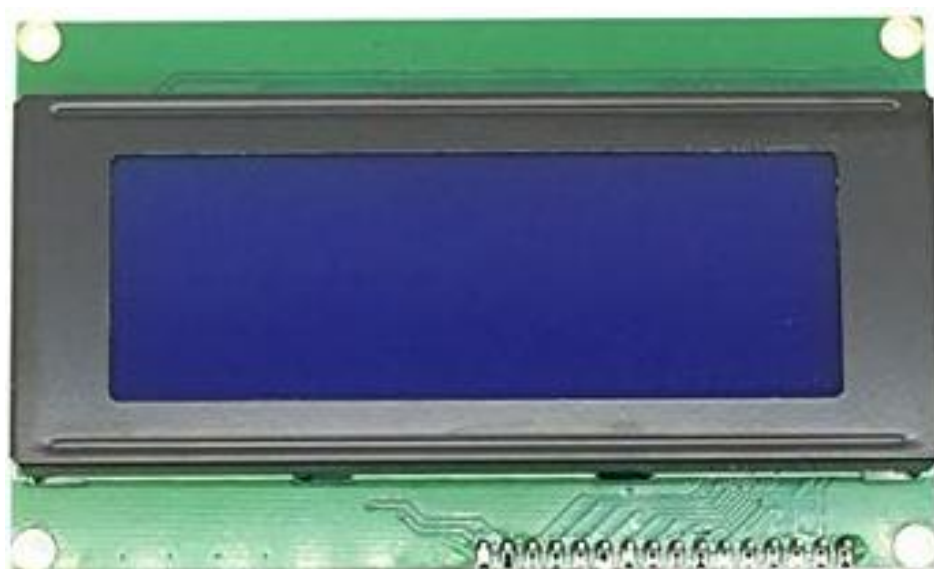
Figura 15: Módulo Display LCD 20x4 com tecnologia I2C utilizado para visualização das informações do projeto
