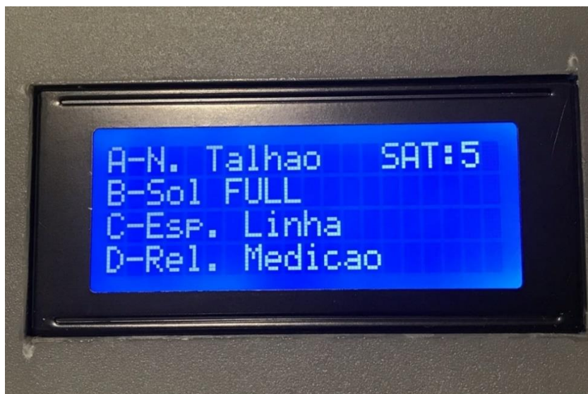
Figura 40: Módulo Display LCD 20x4 com tecnologia I2C utilizado para visualização das informações do projeto
