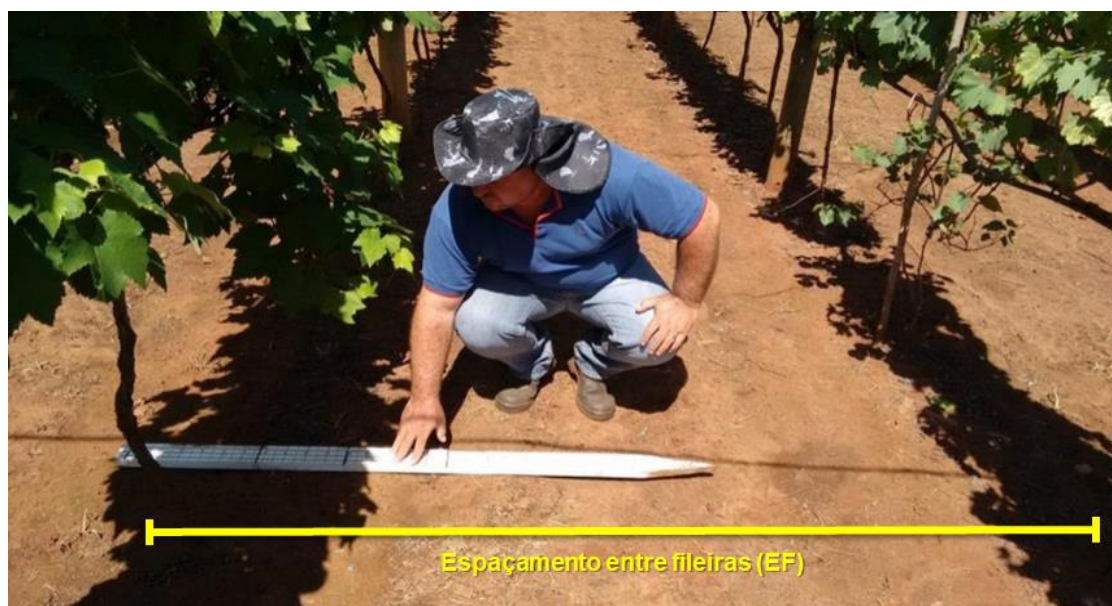
Figura 7: Dispositivo de medição da largura da projeção da copa das videiras
