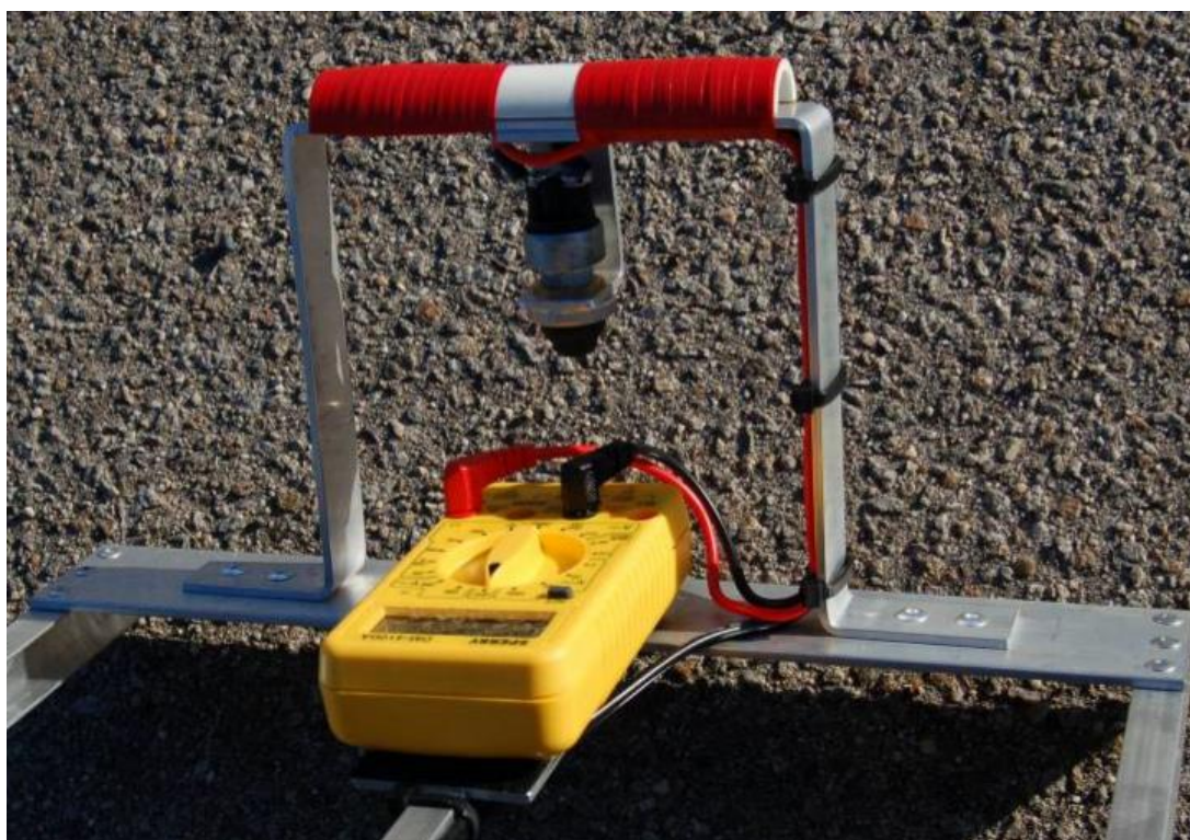
Figura 5: Multímetro digital utilizado para a medição da tensão da placa solar fotovoltaica
