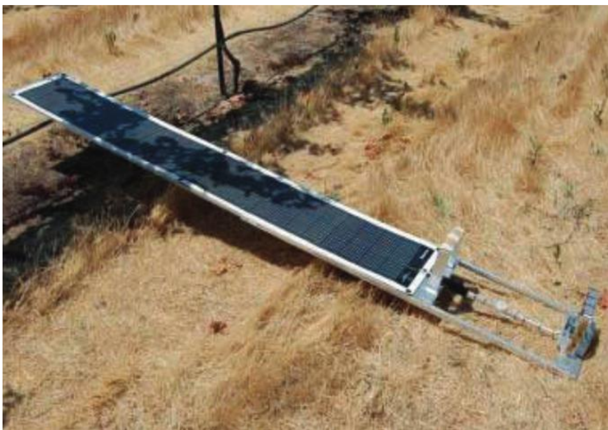
Figura 6: Versão final do dispositivo de medição do sombreamento de videiras apelidado de “Paso Panel”
