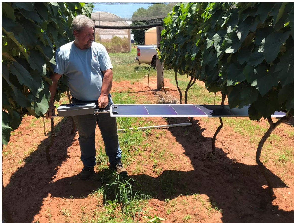
Figura 60: Teste em ponto aleatório utilizando a metodologia de obtenção do coeficiente da cultura ( K_c ) com a sistema da placa solar fotovoltaica
