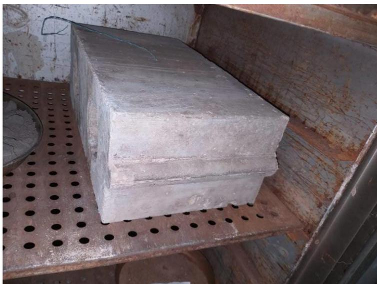
Figura 67 – Pesagem das amostras do bloco de concreto na modulação M -10 após secagem em estufa
