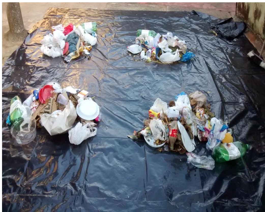
Figura 65– Resíduos divididos para o quarteamento
