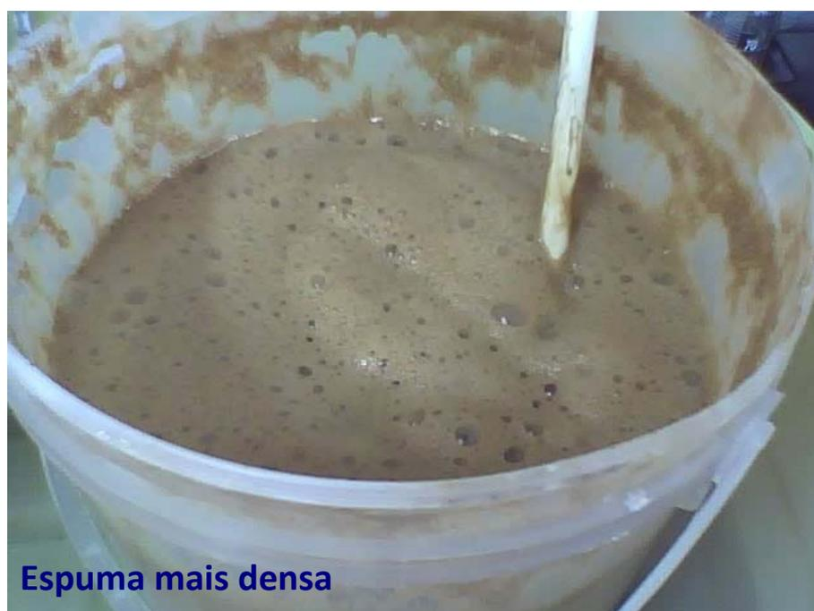
**Figura 5.7: Espuma formada com uso da água como diluente.**
