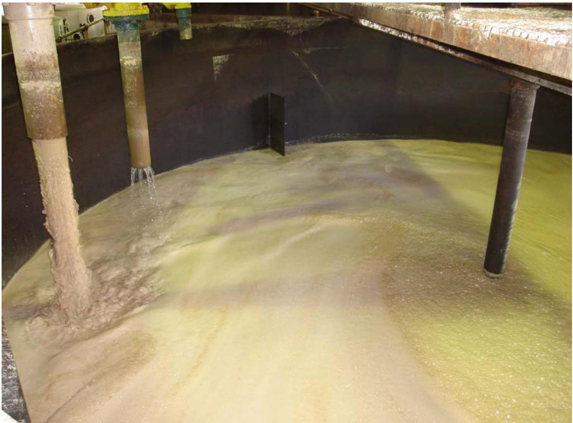
**Figura 3.5: Levedura para fermentação alcoólica. Foto do tanque de equalização da CERP.**
