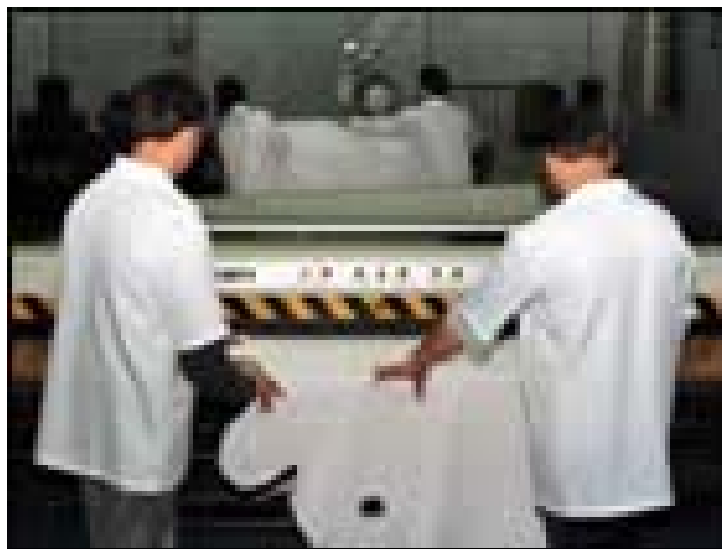
Figura 3.6- Etapa do lixamento do couro.
