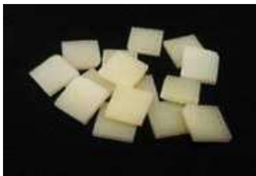
Figura 4. Blocos de dissilicato de lítio após o processo de cristalização
