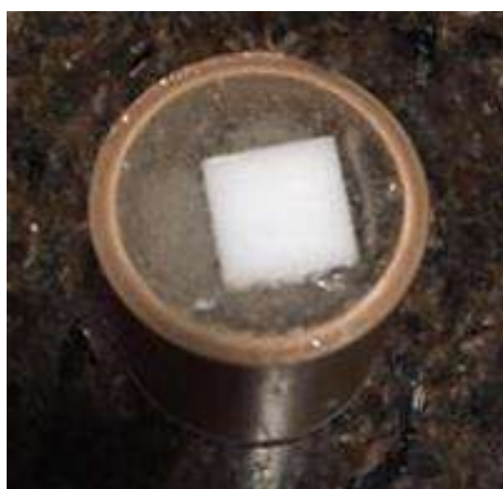
Figura 5: Bloco cerâmico incluído em resina acrílica
