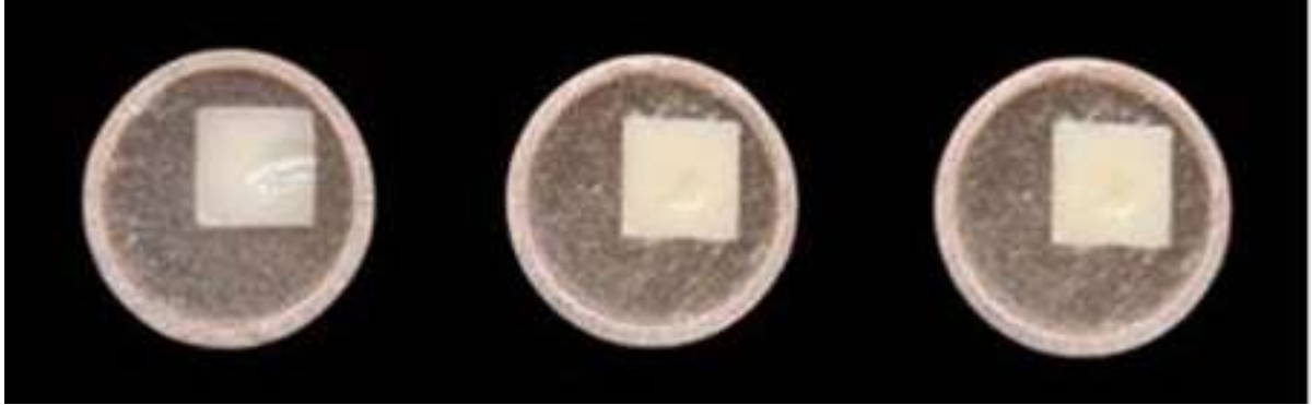
Figura 14: Avaliação qualitativa dos antagonistas cerâmicos. A) Bloco cerâmico de Emax B) Bloco cerâmico de VitaSuprinity C) Bloco cerâmico de Zircom
