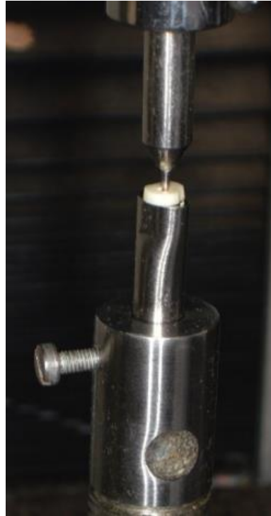
Figura 15. Espécime adaptado à mesa e haste para aplicação de força de deslocamento do cimento.
