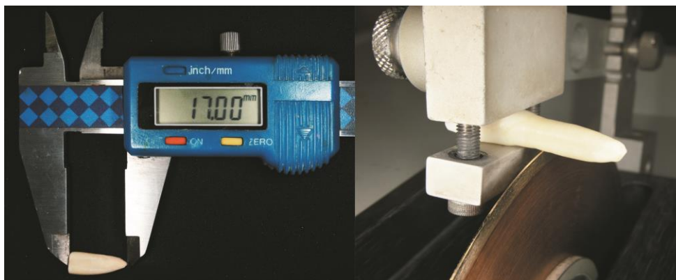
Figura 3. Secção do espécime e padronização do comprimento da raiz em 17 mm.
