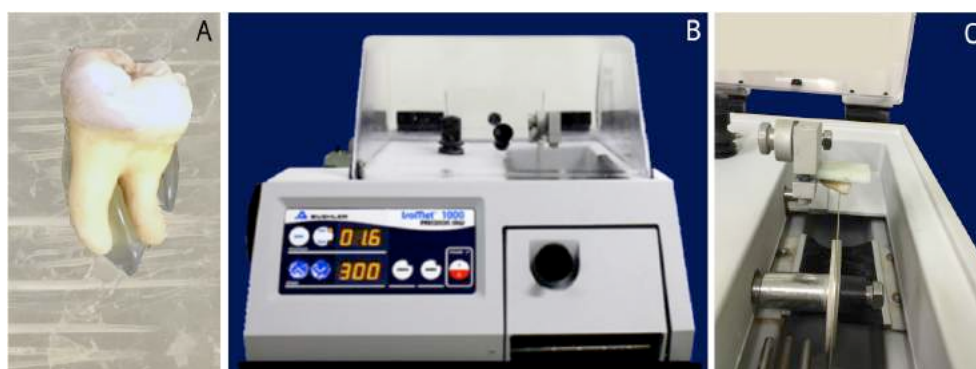
Figura 2. A) Molar inferior humano fixado em placa de acrílico com auxílio de cola quente. B) Máquina de corte Isomet. C) Conjunto placa de acrílico/ dente posicionado na Isomet para secção da coroa a 3 mm da junção amelocementária.
