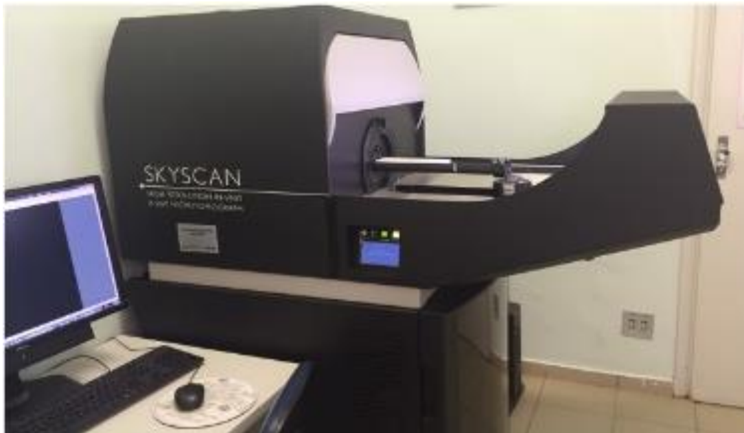
Figura 4. Microtomógrafo SkyScan modelo 1176 (SkyScan, Kontich, Bélgica).
