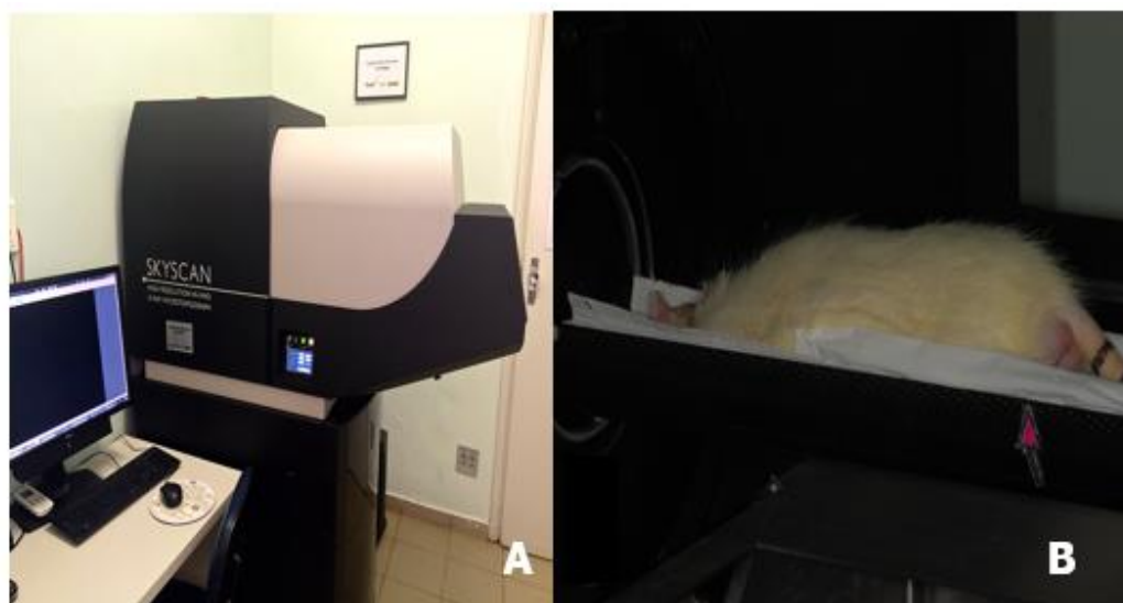
Figura 3. A) Microtomógrafo SkyScan modelo 1176 (SkyScan, Kontich, Bélgica). B) Animal posicionado na porção central da cama de fibra de carbono no interior do microtomógrafo com a calvária paralela ao longo eixo do suporte.
