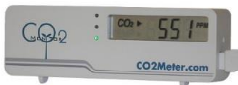
Figura 11 – Equipamento Mini CO 2 RAD-0301 usado como detector de CO 2 na Biblioteca
