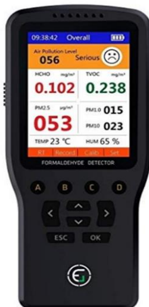
Figura 10 – Equipamento EGVOC-180 usado como detector de QAI na Biblioteca
