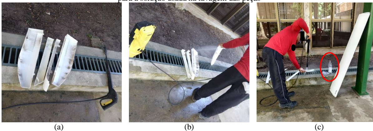
Figura 45 – Lavagem das peças do maquinário: (a) peças antes da lavagem; (b) lavagem das peças; (c) detalhe para a solução usada na lavagem das peças
