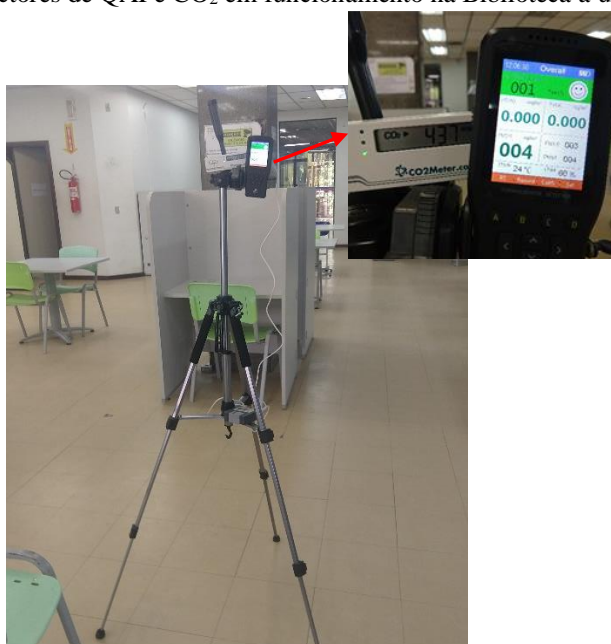
Figura 12 – Equipamentos detectores de QAI e CO 2 em funcionamento na Biblioteca a uma altura de 1,5 m
