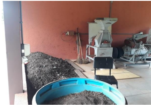
Figura 10: Triturador central de compostagem
