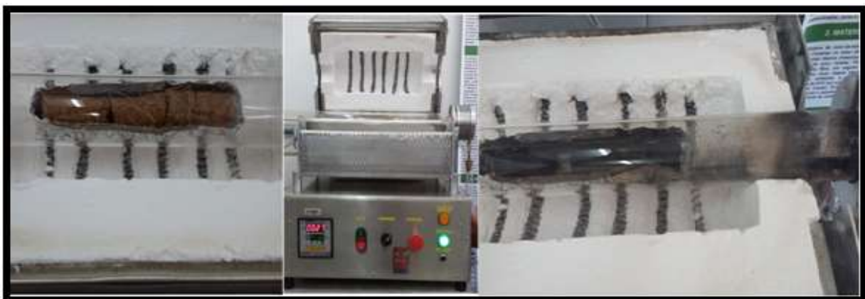
Figura 16: Processo de obtenção de carvão em reator pirólise de leito fixo.
