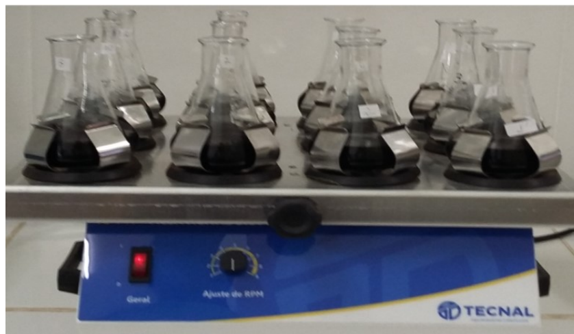
Figura 21: Determinação do índice de Azul de Metileno
