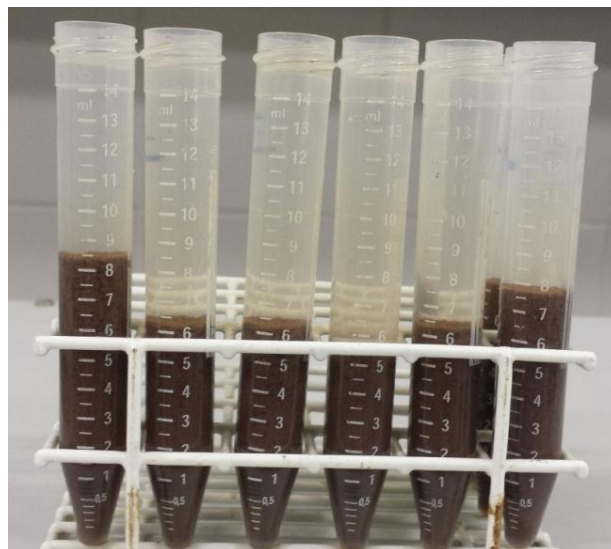
Figura 45: Preparação dos tubos graduados com fundo cônico utilizados nos ensaios de centrifugação com lodo e polímero para realização dos ensaios de desaguamento em centrífuga.
