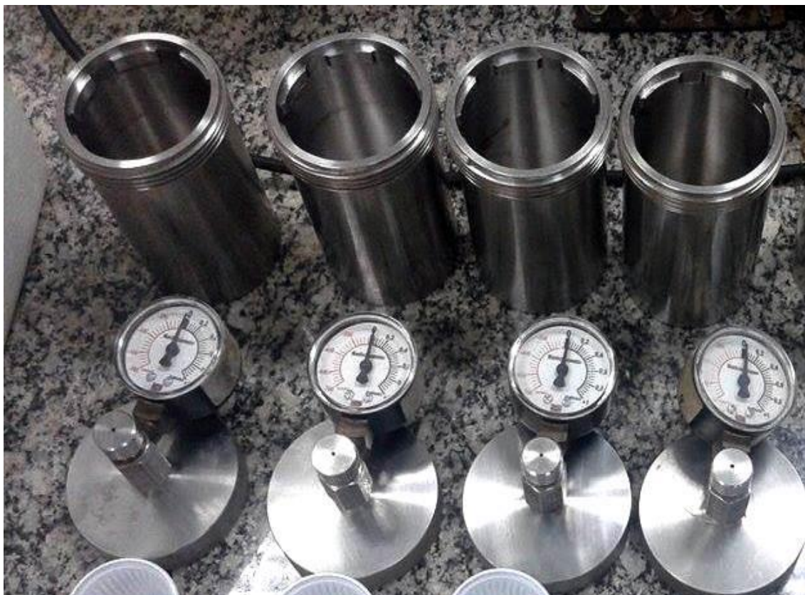
Figura 7 – Biodigestores utilizados no experimento antes do preenchimento.
