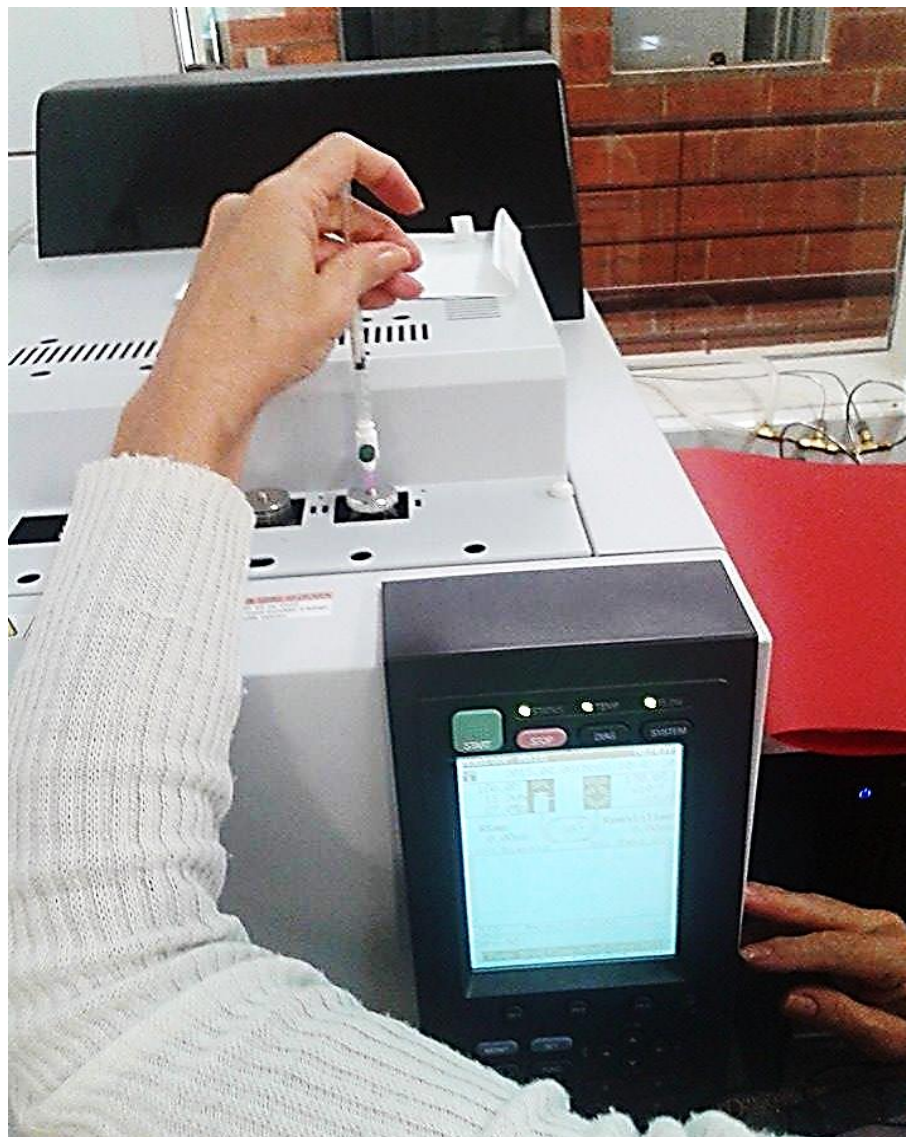
Figura 15 – Inserção do biogás no Cromatógrafo Gasoso Shimadzu GC-2014
