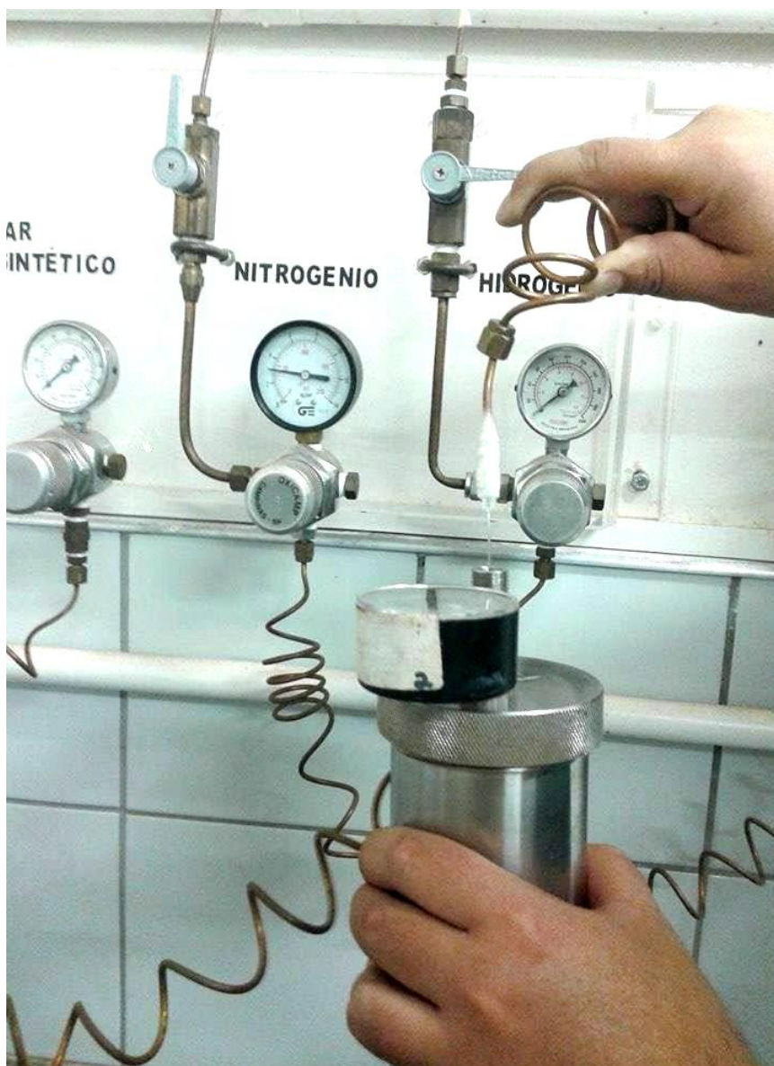
Figura 12 – Inserção do gás nitrogênio no biodigestor
