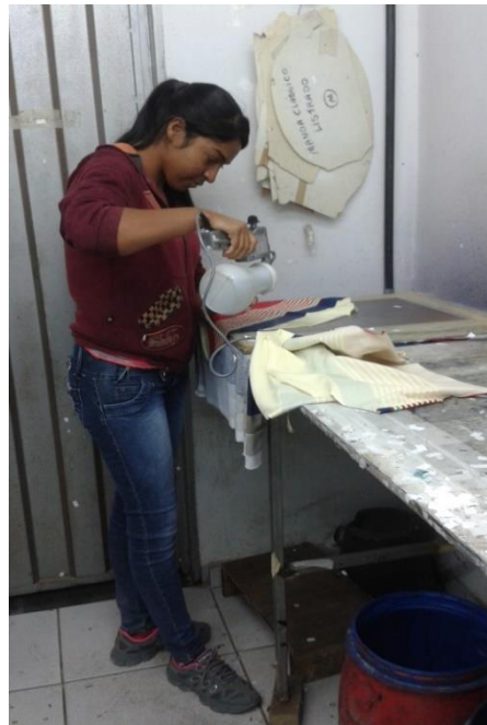
Figura 55 – Limpeza de borrões de tinta nas peças com jato d'água
