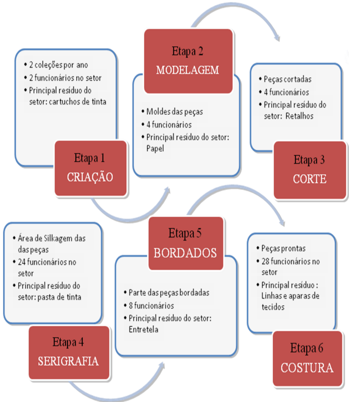
Figura 25 – Processo produtivo da indústria de estamparia têxtil situada na cidade de Divinópolis – MG
