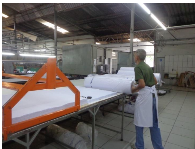
Figura 29 – Equipamento mecânico para enfestar tecidos
