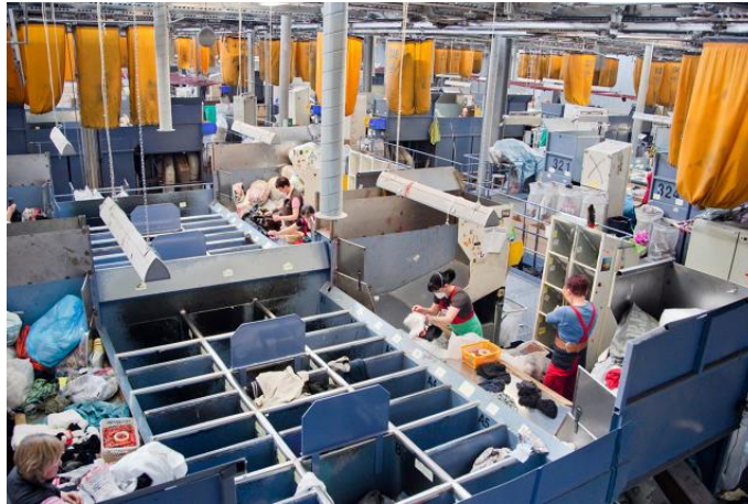
Figura 35. Instalação para o processo de triagem têxtil da Soex
