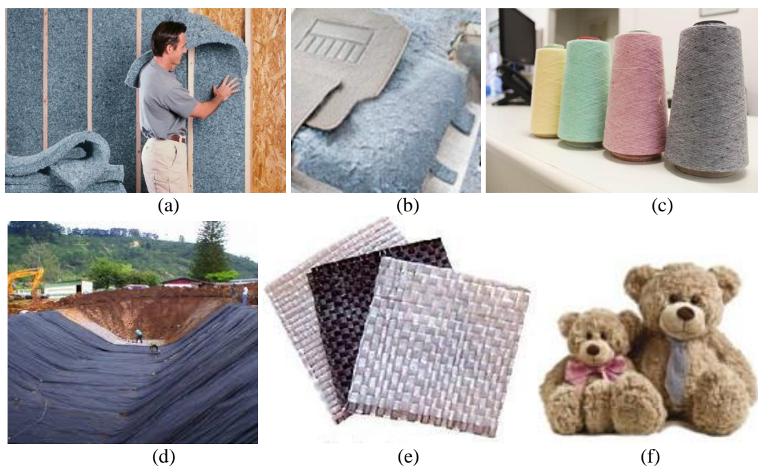
Figura 31. Produtos Fabricados com Utilização de Desfibrados Têxteis: (a) manta acústica; (b) revestimento automotivo; (c) fios e barbantes; (d) geossintético; (e) geotêxtil e; (f) pelúcias
