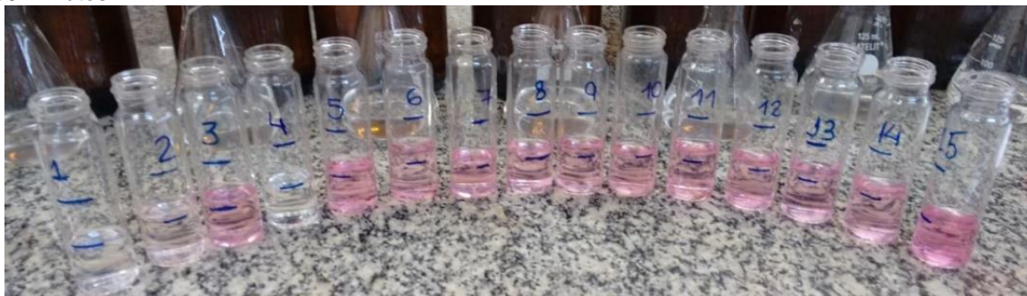
Figura 14 - Determinação do cloro residual livre de cada frasco por DPD após tempo de contato de 30 minutos
