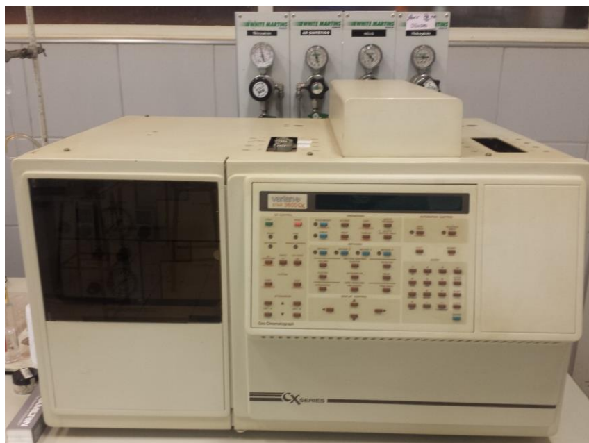
Figura 12 - Cromatógrafo a gás com detector de captura de elétrons para análise e quantificação dos SOH
