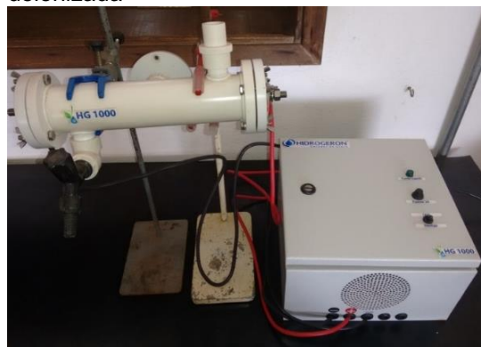
Figura 9 - Equipamento para geração de hipoclorito in loco a partir de NaCl e água deionizada
