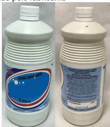
Figura 8 - Solução comercial de hipoclorito de sódio com teor de cloro ativo entre 2 a 2,5% informado pelo fabricante
