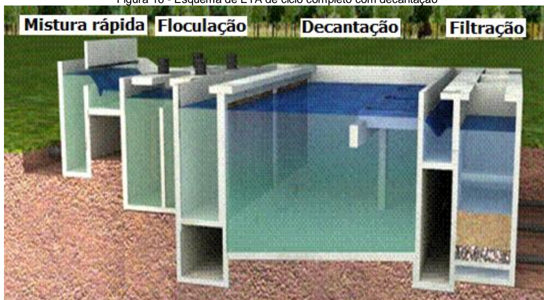
Figura 16 - Esquema de ETA de ciclo completo com decantação
