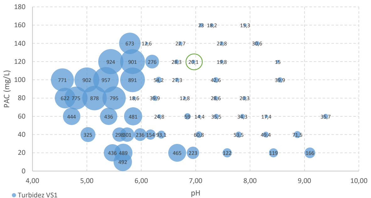
Figura 36 – Turbidez da água decantada em função da dosagem do coagulante PAC e do pH de coagulação para a velocidade de sedimentação 1 de 3,0 cm/min.
