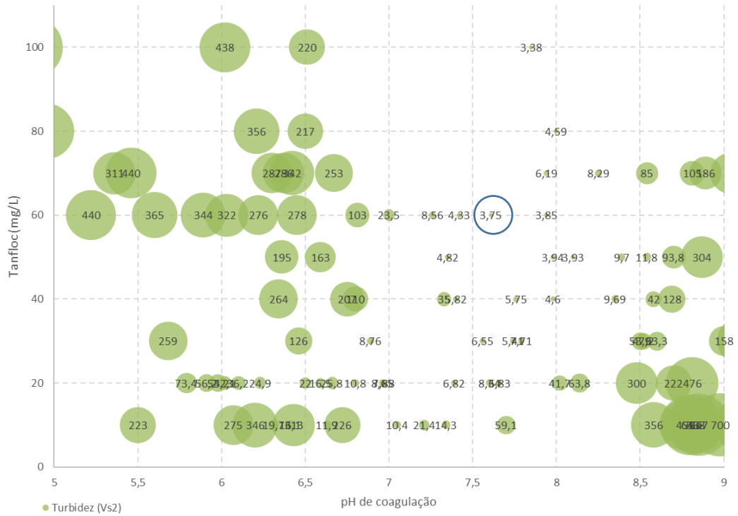
Figura 42 – Turbidez da água decantada em função da dosagem do coagulante Tanfloc SG e do pH de coagulação para a velocidade de sedimentação 2 de 1,5 cm/min
