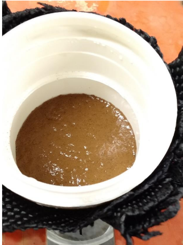
Figura 45 – Lodo retido no geotecido após a filtração.
