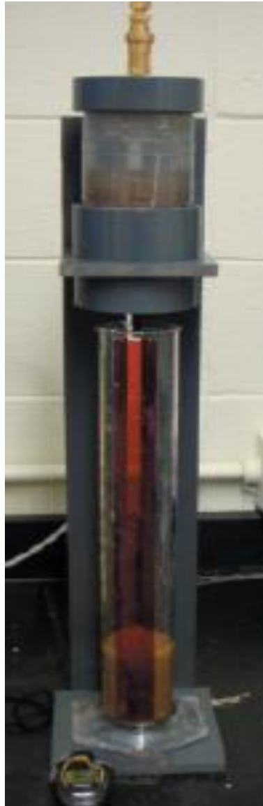
Figura 22 - Unidade de filtração em geotecido com aplicação de pressão na parte superior.
