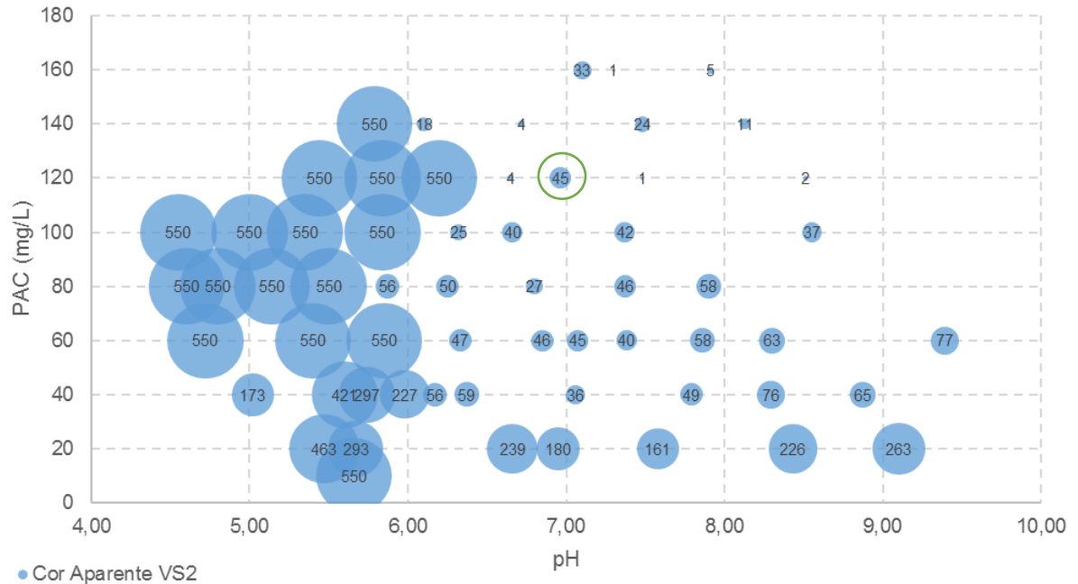
Figura 39 – Cor aparente da água decantada em função da dosagem do coagulante PAC e do pH de coagulação para a velocidade de sedimentação 2 de 1,5 cm/min.
