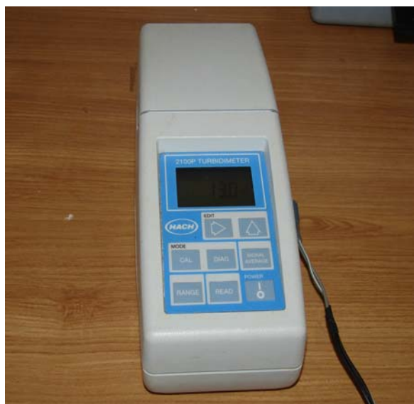
Figura 4.5 Turbidímetro da HACH, modelo 2100 P
