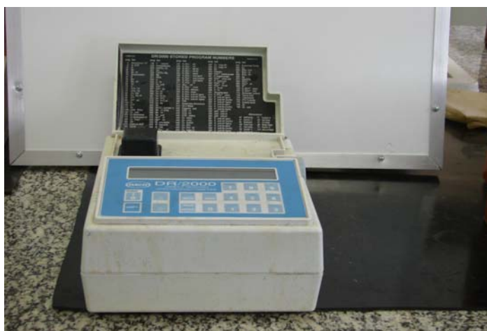
Figura 4.7 Espectrofotômetro DR 2000 HACH
