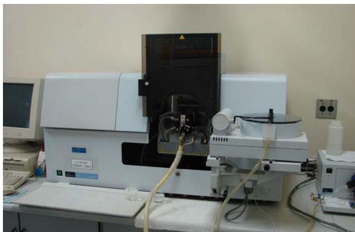
Figura 4.4 Espectrofotômetro de Absorção Atômica
