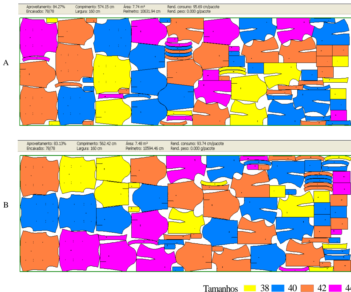
Figura 49 - Mapas de corte da camiseta nas modelagens Nominal (A) e Menor Aproveitamento Possível (MAP) (B)
