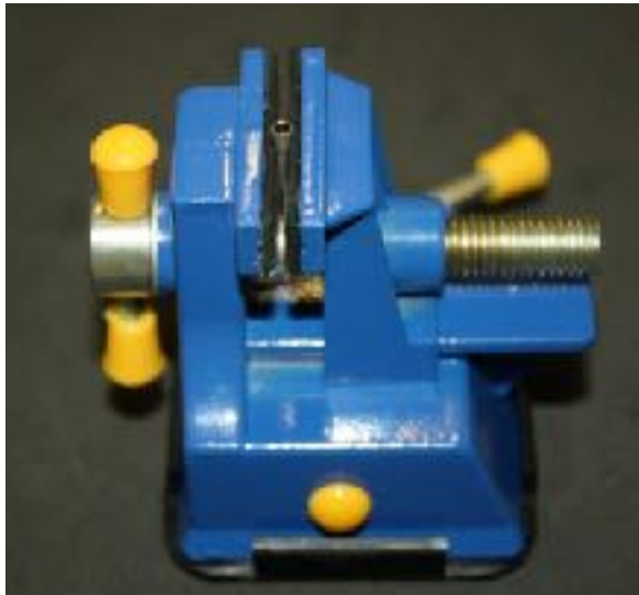
Figura 3. Implante fixado em morsa para padronizar a instalação do conector protético.
