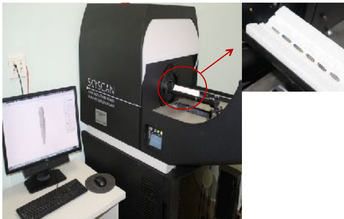
Figura 8. Microtomógrafo utilizado no escaneamento, reconstrução e processamento dos conjuntos utilizados (A). Ampliação com detalhe da disposição dos conjuntos no microtomógrafo (B).
