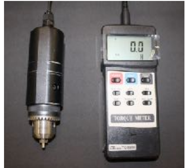
Figura 4. Torquímetro digital utilizado para aplicar o torque dos respectivos conectores aos implantes.
