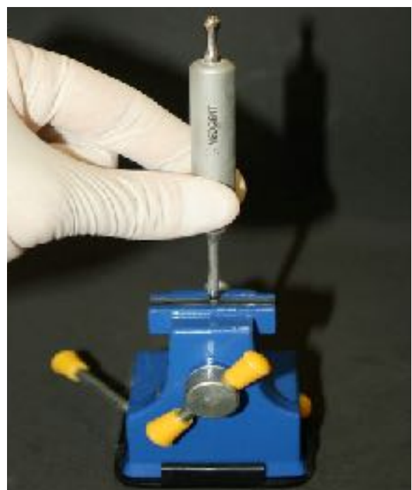
Figura 6. Instalação do micro pilar com martelete Facility.
