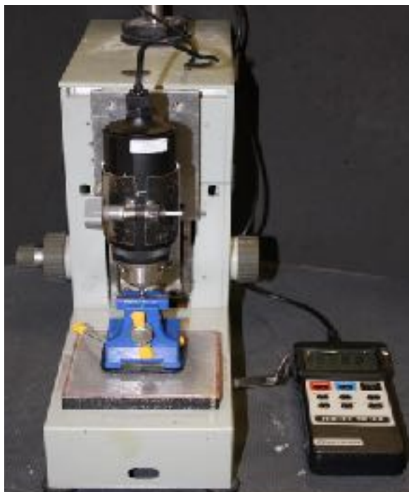
Figura 5. Aplicação do torque sobre o conector protético por meio de torquímetro digital.
