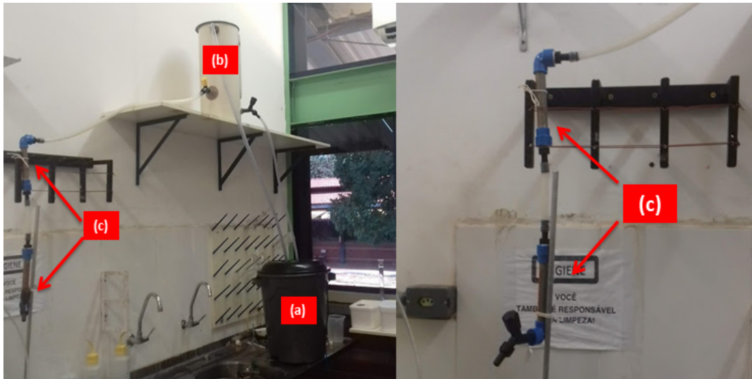
Figura 17. Sistema de filtração de corante em carvão obtido da pirólise de bagaço de cana-de-açúcar. (a) Reservatório inferior, (b) Reservatório superior, (c) Filtro de carvão e areia
