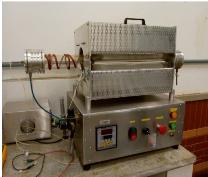
Figura 15. Reator de leito fixo de pirólise
