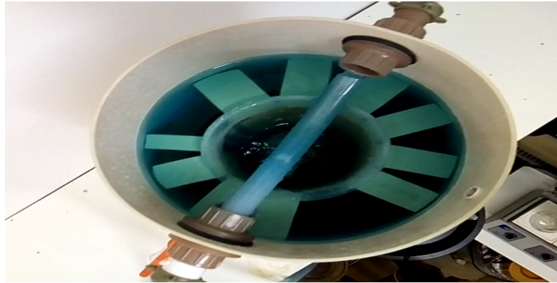
Figura 18. Sistema de filtração de corante em carvão obtido da pirólise de bagaço de cana-de-açúcar
